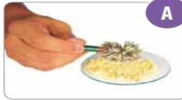
La mezcla de Fe-S se puede separar mediante un imán.
